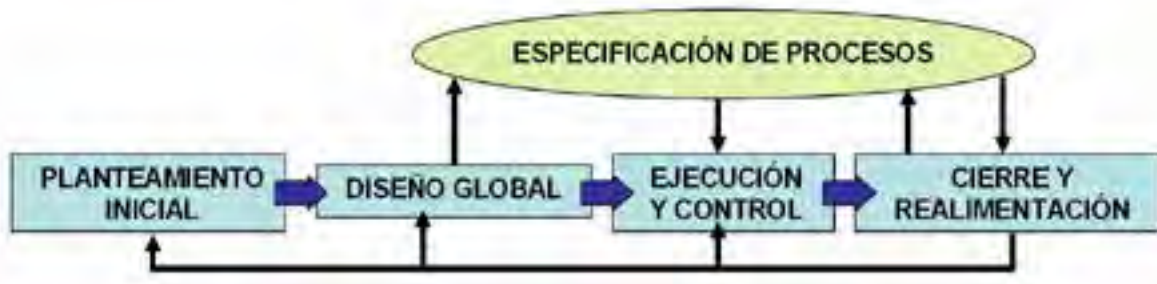
Fig. 3: Esquema básico para realizar anteproyectos (Basoredo, 2010)
